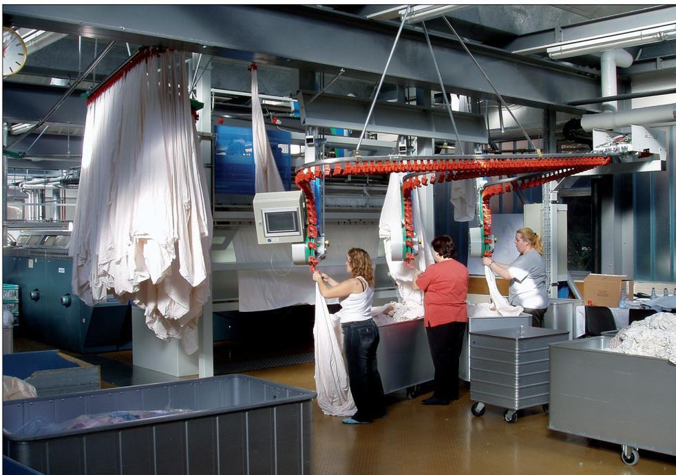
Therese ist eine vollautomatische Eingabemaschine für Grossteile, mit hoher Leistung und Eingabequalität.
