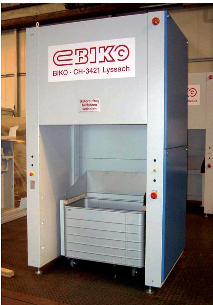
Fanny ist ein Hub- / Kippgerät zur automatischen Beladung von Trockner, Waschschleudermaschinen, Bänder, etc.
