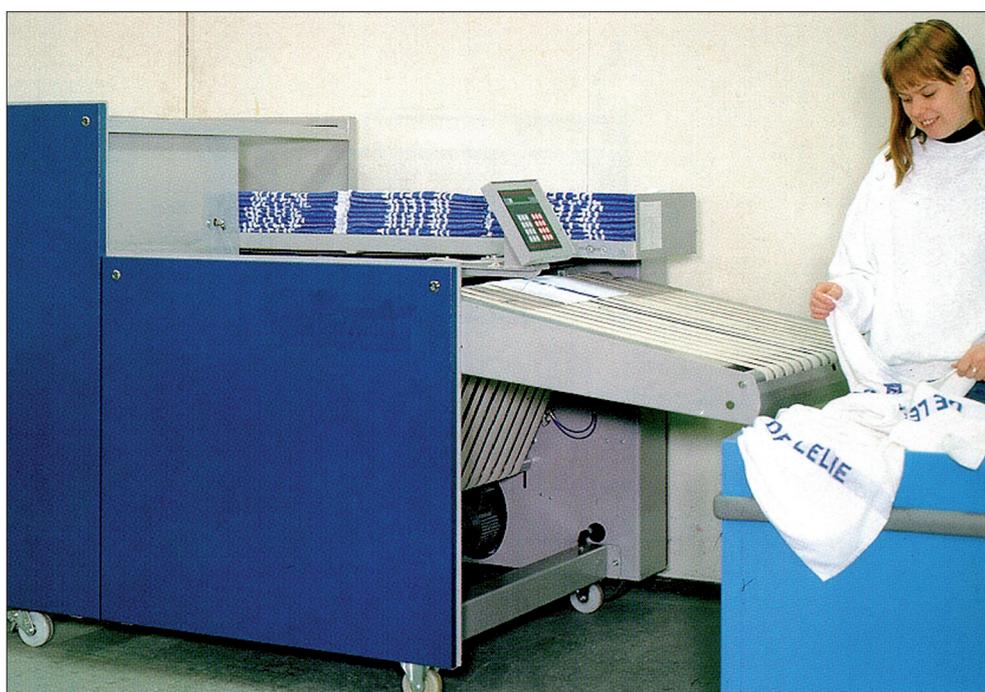
Die Standardmaschine Tina 2/1 wird für das Falten von Frotteetüchern, Windeln, Sonderteilen etc. eingesetzt.
